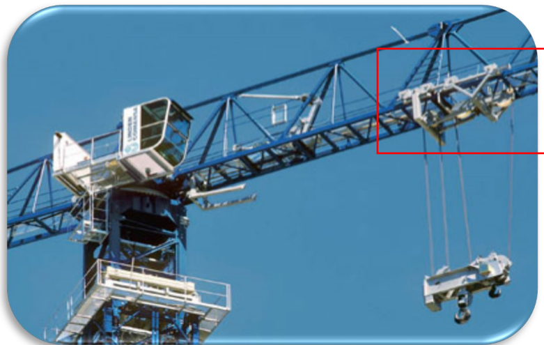
Figura 11: Pluma de la grúa torre
