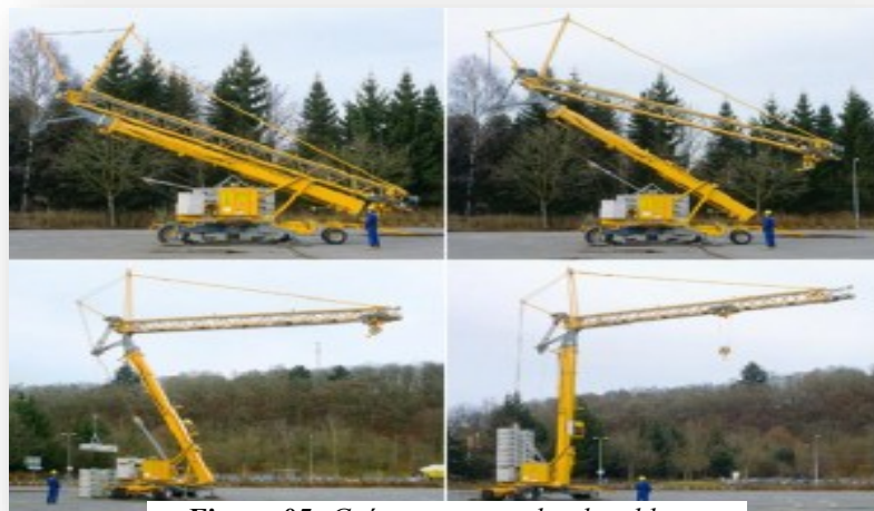
Figura 05: Grúa torre auto desplegable en proceso de despliegue
